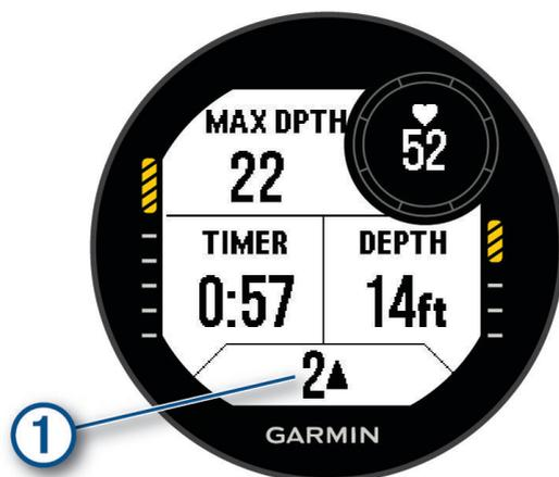
**Экран данных погружения:** отображение информации о текущем погружении, включая прошедшее время, текущую и максимальную глубину, частоту пульса, а также скорость всплытия или погружения. Можно изменить три поля данных (*Настройка экранов данных*, стр. 41).
