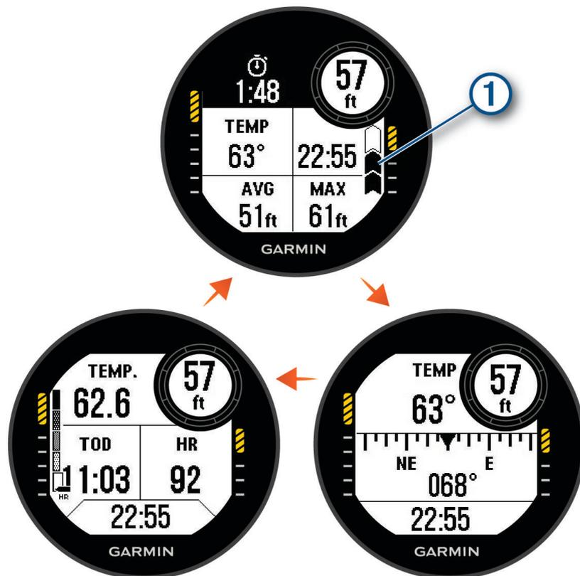
**Секундомер для дайвинга:** отображение секундомера, средней глубины, максимальной глубины, а также скорости всплытия (*Использование секундомера датчика погружения*, стр. 17).
