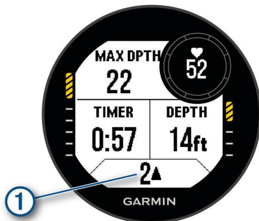
**Экран данных погружения:** отображение информации о текущем погружении, включая прошедшее время, текущую и максимальную глубину, частоту пульса, а также скорость подъема или погружения. Можно изменить три поля данных (*Настройка экранов данных, стр. 41*).
