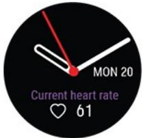
При включенной функции часы непрерывно измеряют вашу частоту пульса и отображают ее на циферблате «ЧСС». При открытии информации вы можете проверить свое самое высокое и самое низкое значение за день, а также узнать самый низкий показатель ЧСС за предыдущую ночь.
