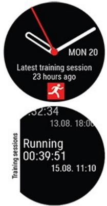
В режиме отображения времени используйте кнопки ВВЕРХ и ВНИЗ, чтобы перейти на циферблат **Последние тренировки**, а затем нажмите ОК.
