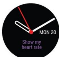
Если вы не используете функцию **Непрерывное отслеживание ЧСС**, вы можете быстро проверить вашу текущую частоту пульса, не начиная тренировки. Просто затяните браслет, выберите этот циферблат, нажмите ОК, и на часах сразу же отобразится ваша текущая ЧСС. Вернитесь к циферблату ЧСС, нажав НАЗАД.
