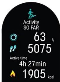
Круг вокруг циферблата и процентное значение под датой и временем отображают ваш прогресс в достижении цели суточной физической активности. Круг заполняется светлосиним цветом, пока вы активны.
