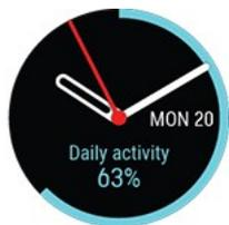
Круг вокруг циферблата и процент ниже даты и времени отображают ваш прогресс в достижении цели суточной активности. Круг заполняется светло-синим цветом, пока вы активны.
