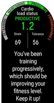
**Статус кардионагрузки** рассматривает отношение между краткосрочной тренировочной нагрузкой (**Напряжением**) и долгосрочной тренировочной нагрузкой (**Выносливостью**), и на его основе показывает, какой у вас статус тренировочной нагрузки: детренированность, поддержание, эффективно или перетренированность.
