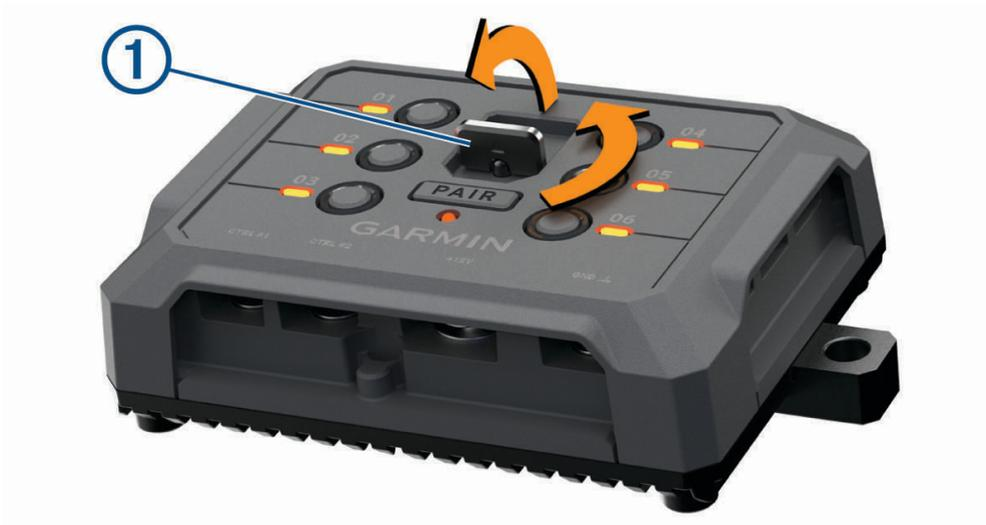
2 Снимите переднюю крышку с устройства.
