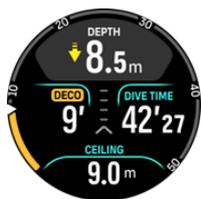
При всплытии выше безопасной граничной области расчет декомпрессии приостанавливается, пока вы не опуститесь ниже этого предела. В случае небезопасной декомпрессии подается звуковой сигнал и перед значением глубины потолка появляется красная стрелка вниз. Если вы проигнорируете это предупреждение и продолжите находиться выше безопасной граничной области в течение трех минут, остановка будет считаться пропущенной и появится уведомление о нарушении алгоритма.
