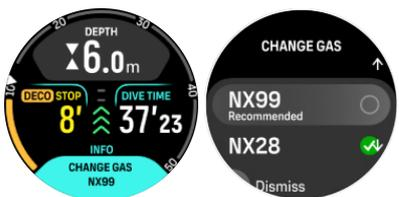
6. Достижение глубины последней остановки. Как только время декомпрессии заканчивается, значок декомпрессии исчезает и остановка переходит в остановку безопасности. В этом примере остановка безопасности установлена на Настроено, поэтому обратный отсчет начинается на отметке 1'30 из-за более длительного пребывания на глубине 6 м.
