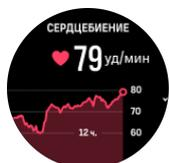
В виджете отображается текущее значение пульса, а также доступен график ЧСС за 12-часовой период. График строится по средней частоте сердечных сокращений по 24-минутным интервалам.
