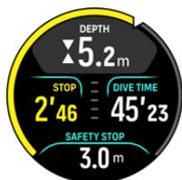
Есть два типа остановок безопасности: необязательные и обязательные. Остановка безопасности обязательна, если во время погружения произошло превышение рекомендуемой максимальной скорости подъема. Если остановка обязательна, то при подъеме на глубину менее 2,4 м в окне индикации появятся красные стрелки. Если остановка необязательна, в окне появится только желтая стрелка.
