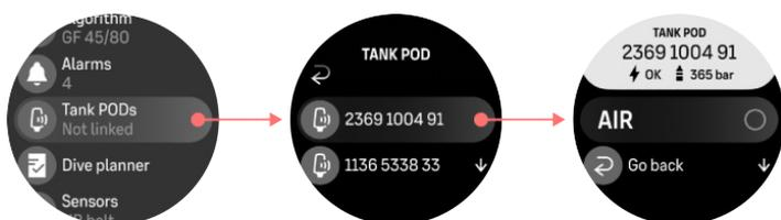
**Сопряжение устройств(a) Suunto Tank POD также можно выполнить из меню Газ. смеси:**
