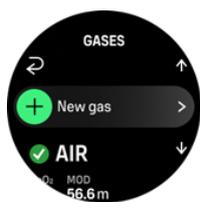
Используемую газовую смесь нельзя удалить. Если вы хотите изменить используемую газовую смесь, вам потребуется либо внести изменения в существующую газовую смесь, либо создать новую и установить для нее статус используемого газа. Если вы измените используемую газовую смесь, предыдущая газовая смесь может быть как отключена (Одногазовый режим), так и включена (Многогазовый режим).
