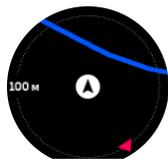
На экране пошаговой навигации, можно нажать нижнюю кнопку, чтобы открыть меню навигации. Меню ускоряет доступ к навигационным действиям (например, к сохранению текущего местоположения или выбору другого маршрута для навигации).
