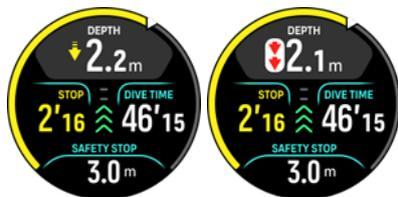
При погружении на глубину ниже 6 м (20 фт.) во время выполнения остановки, таймер остановки безопасности остановится, и отсчет возобновится, только когда вы снова окажетесь внутри окна остановки безопасности. Как только на таймере появится ноль, остановка будет завершена, и вы сможете подняться на поверхность.
