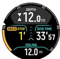
Плавная режим подъема: в этом случае значение потолка постоянно уменьшается, при условии что дайвер постоянно находится примерно на уровне глубины потолка. В результате достигается плавная декомпрессия с оптимальным временем подъема.
