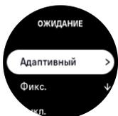
5. Если параметр имеет только два значения (например, «Вкл.» и «Выкл.»), чтобы изменить его, коснитесь параметра или нажмите среднюю кнопку.
