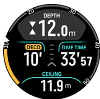
Если при подъеме вы превысите глубину потолка, у вас все еще останется безопасная граничная область, равная глубине потолка минус 0,6 м (2 фт.). В этой безопасной граничной области расчет декомпрессии по-прежнему продолжается, однако рекомендуется опуститься ниже глубины потолка. Это будет указано с помощью желтой стрелки вниз рядом со значением глубины.
