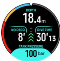
5. Скорость подъема можно отслеживать на Индикаторе скорости подъема. При превышении рекомендуемого максимального значения 10 м/мин индикатор становится красным и подается звуковой и вибрационный предупредительный сигнал. Чтобы подтвердить этот сигнал, нажмите любую кнопку.
