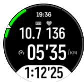
На часах отобразится уведомление, когда вы достигнете нужной зоны. В ходе выполнения упражнений часы предупреждают о необходимости ускориться или замедлить темп, если текущий показатель сердцебиения, темпа или мощности выходит за пределы выбранной целевой зоны.
