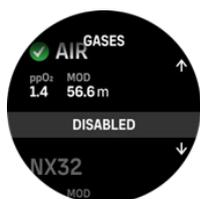
В режиме Одногазовый может быть только один используемый газ. При создании новой газовой смеси вы можете выбрать ее в качестве используемого газа. Также вы можете сохранить наиболее часто используемую газовую смесь (например, NX32), чтобы ее можно было легко включить, когда она вам понадобится.
