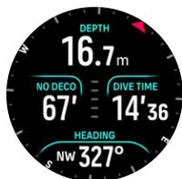
Установить азимут можно продолжительным нажатием средней кнопки. После установки азимута отображается уведомление, а на дуге компаса появляется указатель азимута, который показывает установленное направление. После того как азимут установлен, указатель азимута фиксируется на дуге компаса, указывая установленное направление. Оранжевый сегмент, который отображается на противоположной от указателя стороне дуги, показывает обратное направление (180 градусов).
