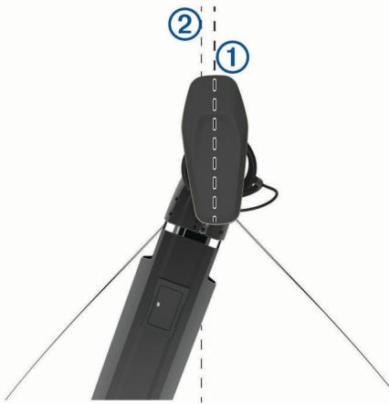
2 На панели троллингового мотора выберите **≡ > Калибр.вать > Смещен. носа.**
