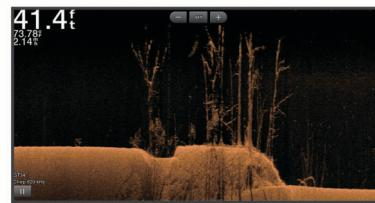
В обычных датчиках используются конусообразные лучи. Для сканирующего сонара Garmin ClearVü предусмотрено использование двух узких лучей, схожих по форме с лучом копировального аппарата. Эти лучи обеспечивают более четкое, напоминающее фотографию изображение пространства под судном.
