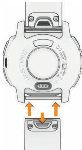
**ПРИМЕЧАНИЕ.** убедитесь, что ремешок закреплен надежно. Фиксатор должен защелкнуться на штырке часов.
