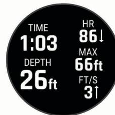
**Экран данных погружения:** отображение информации о текущем погружении, включая прошедшее время, текущую и максимальную глубину, частоту пульса, а также скорость подъема или погружения.
