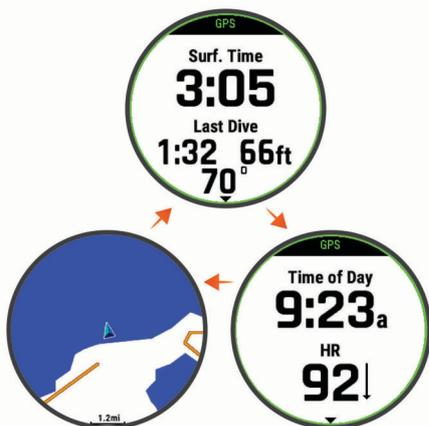
**Экран интервала между погружениями:** отображение текущего времени интервала между погружениями, а также прошедшего времени, максимальной глубины и температуры при последнем погружении в режиме апноэ.
