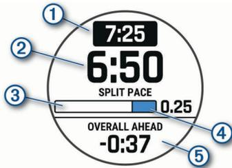
На устройстве отображается целевой темп на отрезке <sup>1</sup>, текущий темп на отрезке <sup>2</sup>, ход выполнения отрезка <sup>3</sup>, расстояние до конца отрезка <sup>4</sup> и общее время опережения или отставания от целевого темпа <sup>5</sup>.
