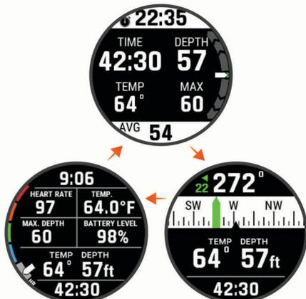
**Секундомер для дайвинга:** отображает секундомер времени на максимальной глубине; текущую, максимальную и среднюю глубину, а также скорость подъема или погружения (*Использование секундомера для дайвинга*, стр. 7).
